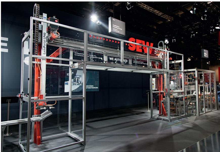
1 Dieses Roboter-Portal zum selbsttätigen Be- und Entladen von Werkzeugmaschinen hat SEW-Eurodrive gemeinsam mit Emag aus Salach konzipiert und gebaut (© SEW-Eurodrive)
