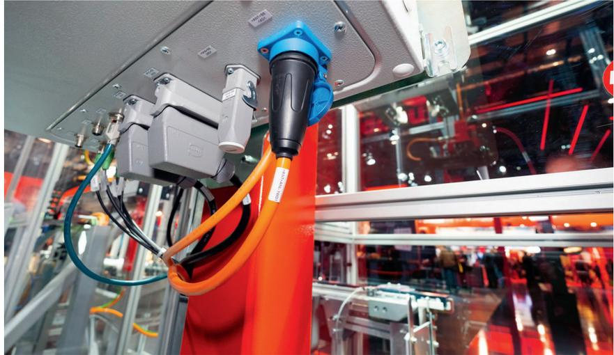
2 Stromversorgung über Schukosteckdose: Die intelligente Energieversorgung mit der Zwischenkreispufferung über Doppelschicht-Kondensator-Pakete macht den Weg frei, die Roboter mit einem 230-V-Anschluss zu versorgen (© SEW-Eurodrive)
